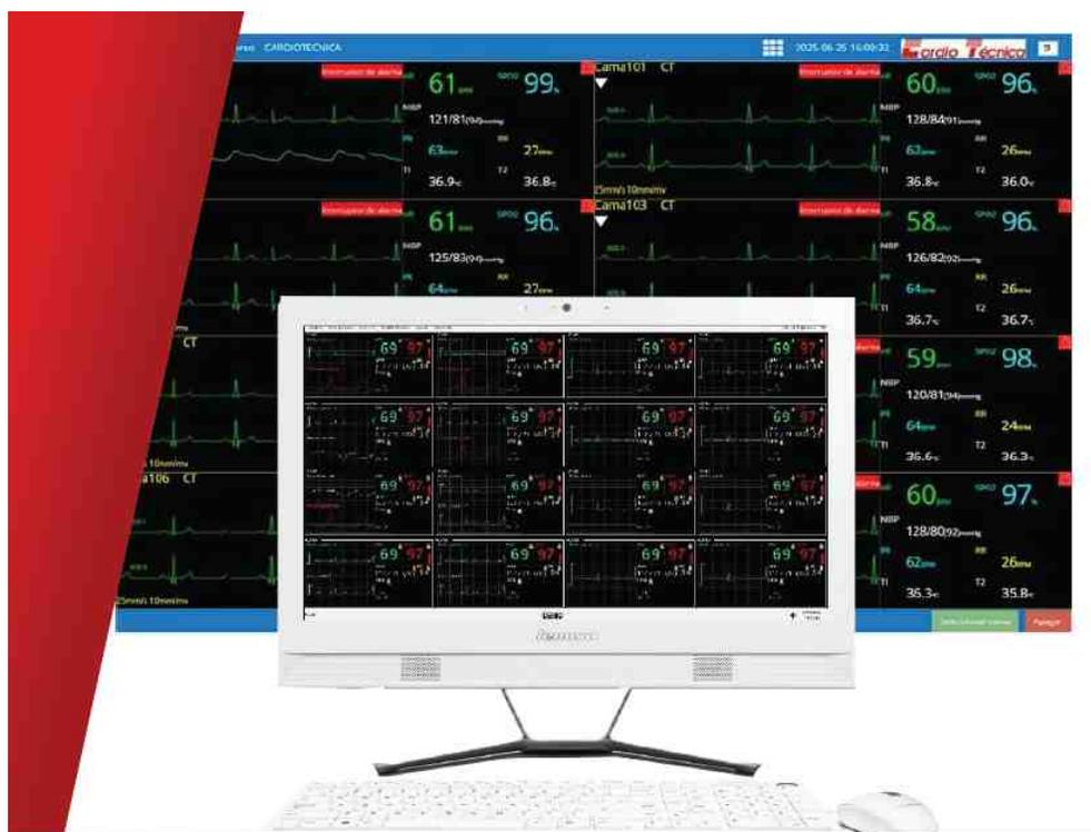
La Central de Monitoreo Multiparamétrico CMS5 está desarrollada para realizar un control centralizado de los Monitores Multiparamétricos Línea MA512. Permite la visualización simultánea de hasta 32 Monitores y brinda la posibilidad de configurar las presentaciones a sus necesidades. Posee la capacidad de reconocer pantallas de todos los tamaños.
