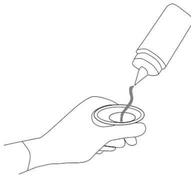
**Figura 46 Agregue un gel de acoplamiento a la hoja de la sonda**
