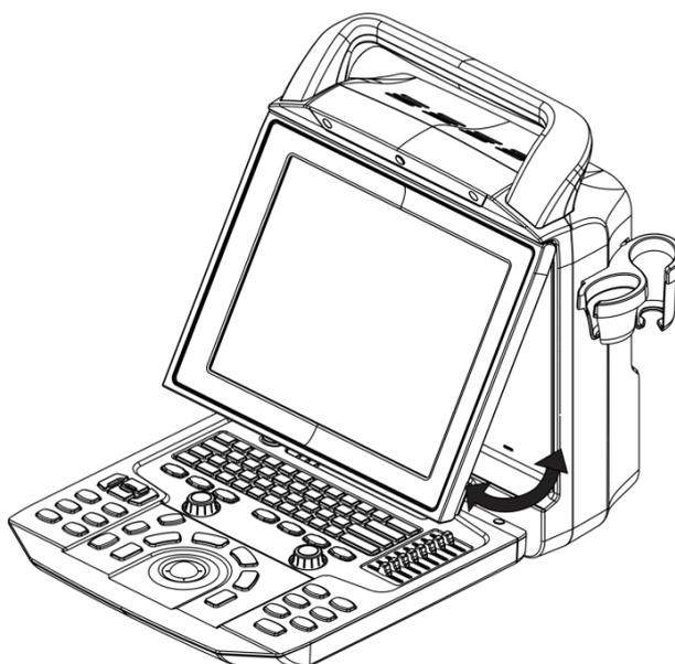
Figura 5 Ajuste de monitor
