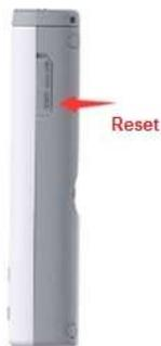
Retire la carcasa protectora y Presione con una punta en el lugar de reset. El Oxímetro se reiniciará.
