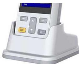
Esta base esta diseñada para mantener en posición vertical el Oxímetro de Pulso OXI-601. La misma tiene un conector de entrada para poder cargar el equipo mientras esta colocado en la base.
