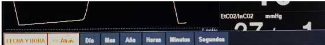
Girando y presionando la perilla se setea la fecha y el reloj del equipo. Se ingresa a la opción por modificar y nuevamente girando la perilla se selecciona el valor a fijar. Estos datos son utilizados en la parte superior de la pantalla y como referencia en el menú de tendencias.
